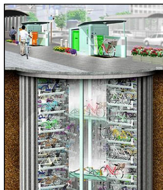
(b) 地下機械式自転車駐車場
